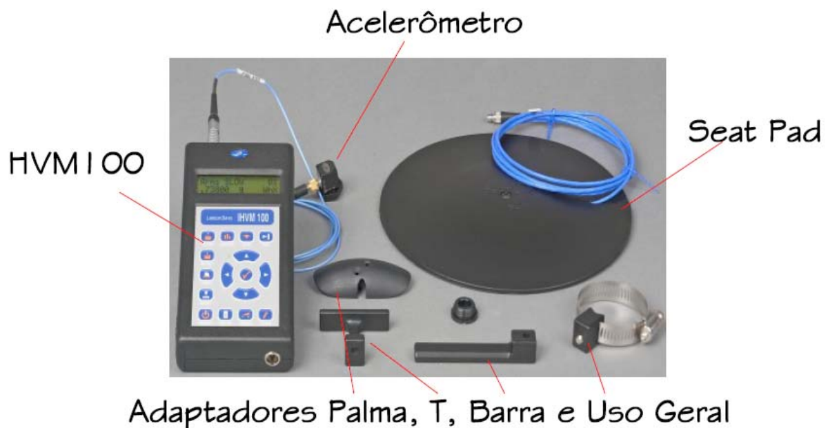
Figura 5.11- Equipamento HVM100 (Grom, 2009).
