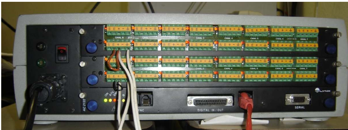
Figura 5.4- Condicionador de sinais AI2164.
