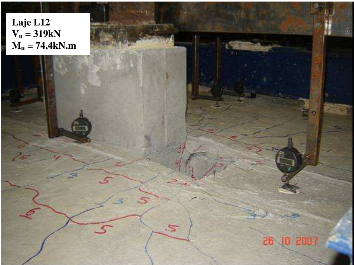
Figura 5.12 – Fotografia das superfícies de ruptura das lajes da Série 2 (continuação)
