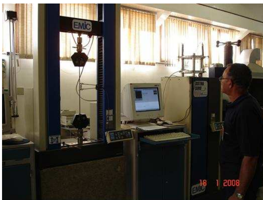
Figura A.1 – Prensa utilizada para o ensaio do aço com 5,0mm de diâmetro
