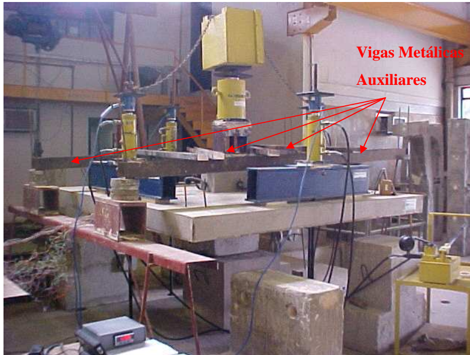
Figura 3.37 – Fotografia da estrutura para fixação dos defletômetros utilizados nas lajes L1 a L4
