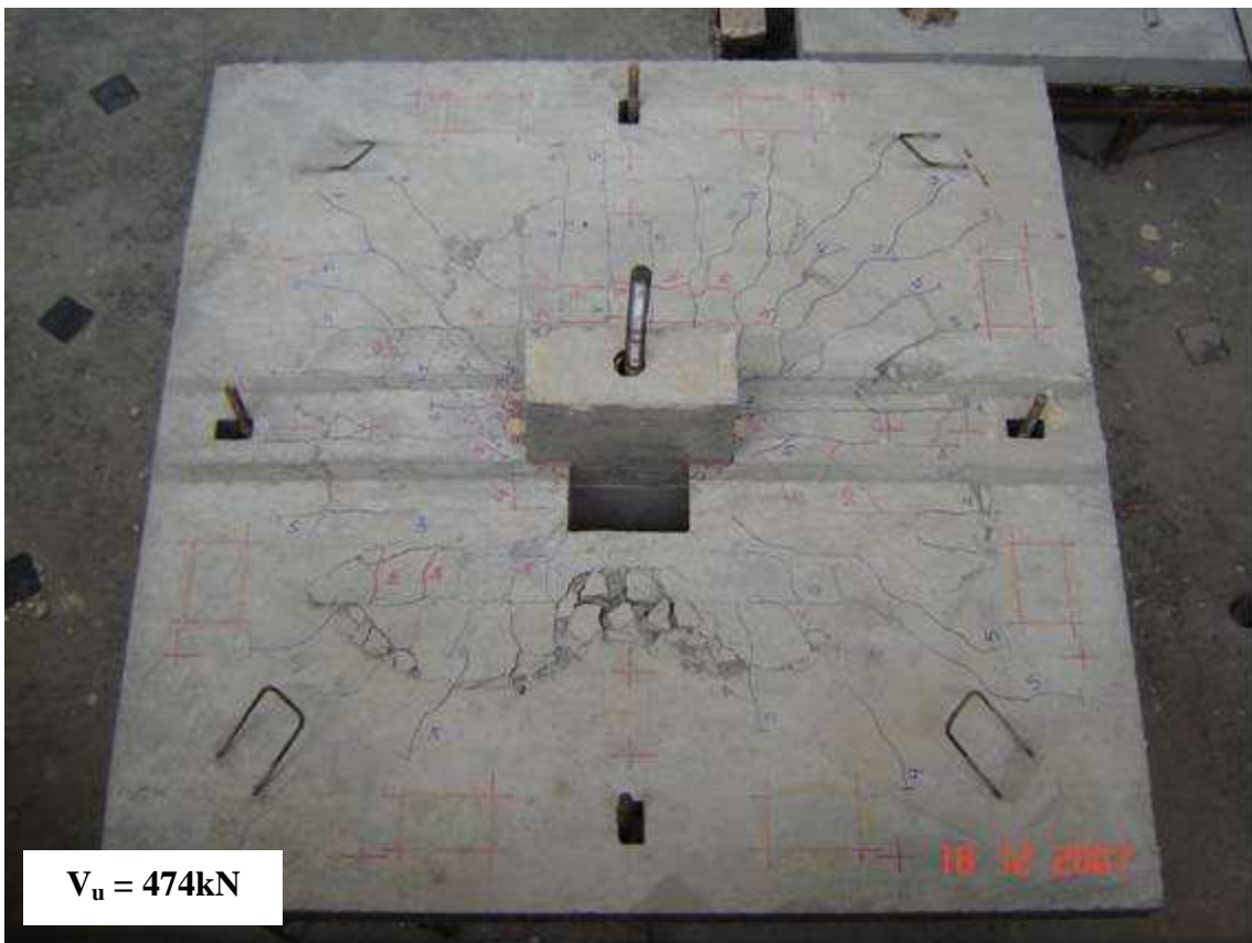
Figura 4.10 – Fissuração na laje L16
