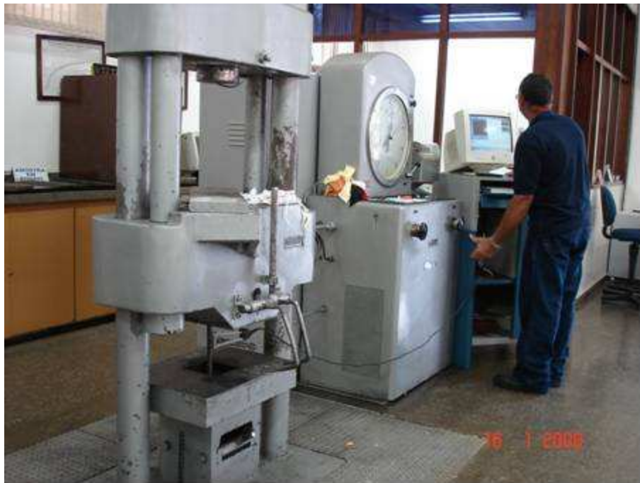
Figura A.3 – Prensa utilizada para o ensaio dos aços com diâmetro maior ou igual a 6,3mm
