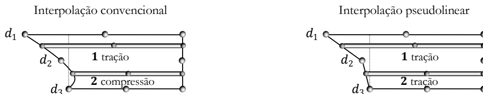
Figura 5.23 - Diferenças na previsão das forças axiais nos reforços pela utilização dos métodos de interpolação convencional e pseudolinear.
