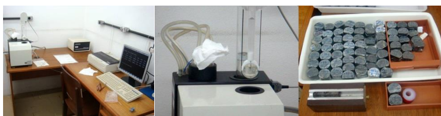
Figure 5.8. Equipment used for laboratory determinations, Kappabridge model KLY-4S (Laboratório de Anisotropias Magnéticas e de Magnetismo de Rocha - Instituto de Geociências - Universidade de São Paulo) .
