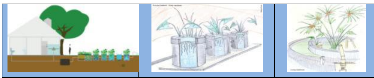
Figura 5.45 - Desenho do sistema de tratamento de águas residuais por "máquinas vivas": coleta e distribuição, reservatórios subterrâneos, bacias de retenção e células aquáticas.
