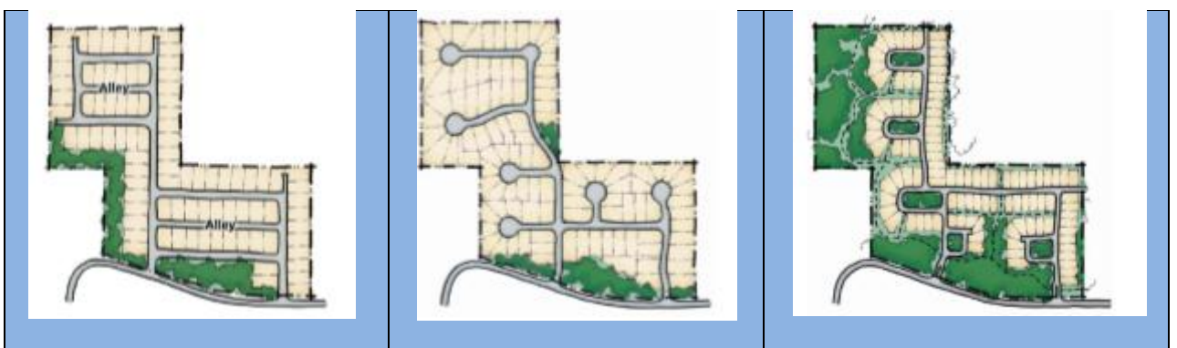
Figura 5.27 - Típicas configurações de vias: malha xadrez com ruas locais, cul-de-sacs, híbridas ou espaços abertos
