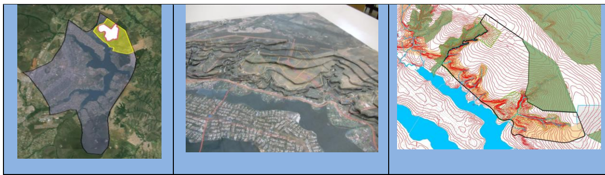
Figura 6.31 – Imagem aérea da Gleba A do Etapa 2 e as curvas de nível demonstrando o caminho das águas em direção aos córregos e ao Lago Paranoá.
