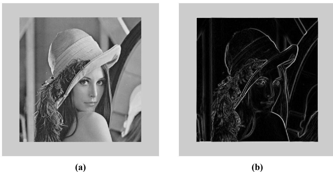
Figura 2.8 – (a) Imagem original. (b) Contorno extraído por Canny Edge detector .
