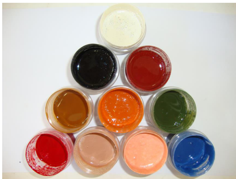
Figura 6. Tintas obtidas a partir da mistura de diversos pigmentos com o veículo sintetizado a partir de óleo residual de fritura. Foto: Guilherme B. C. Martins
