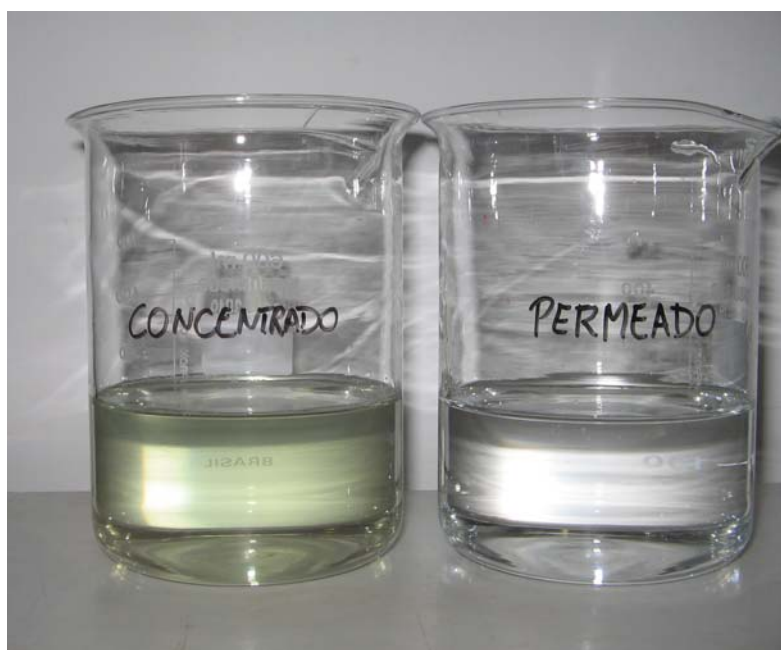
Figura 5.11 - Amostra de permeado coletada na décima hora de duração do ensaio e de concentrado coletada no início do ensaio de remoção de saxitoxinas por nanofiltração.
