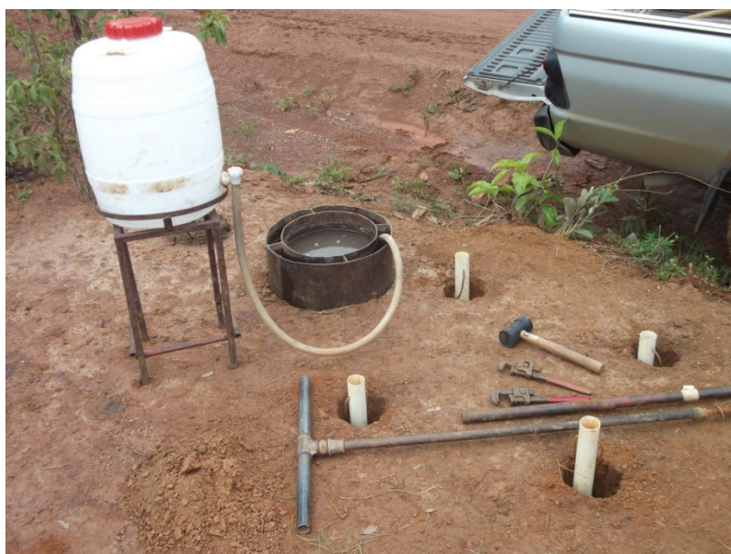
Figura 5.1 - Ilustração de campo mostrando o desenvolvimento de ensaio de infiltração in situ do tipo Anéis Concêntricos e Open End Hole .
