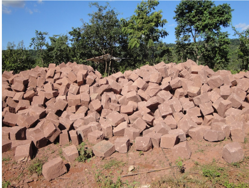
Figura 4.26 - Paralelepípedos amontoados próximos ao local de extração de arenitos da Formação Diamantino. Cada bloco constitui uma porosidade essencialmente matricial, sem a existência de qualquer porosidade secundária planar (UTM 523966 / 8402752).
