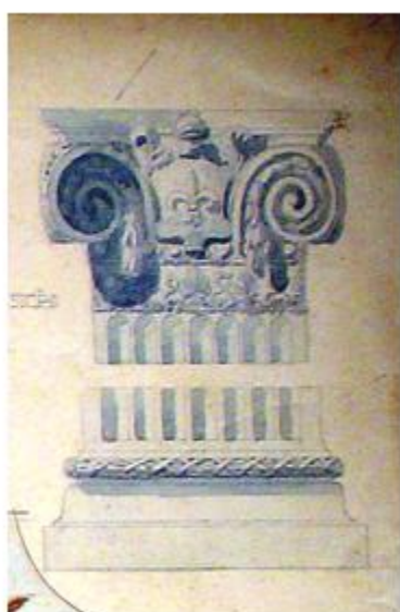
Figuras 63 e 64 - À esquerda, Figura 63, trabalho acadêmico de Atílio Corrêa Lima de 1921, e à direita, Figura 64, trabalho acadêmico de Heitor de Mello – capitel Jônico – cadeira: Elementos de Arquitetura (sem data)
