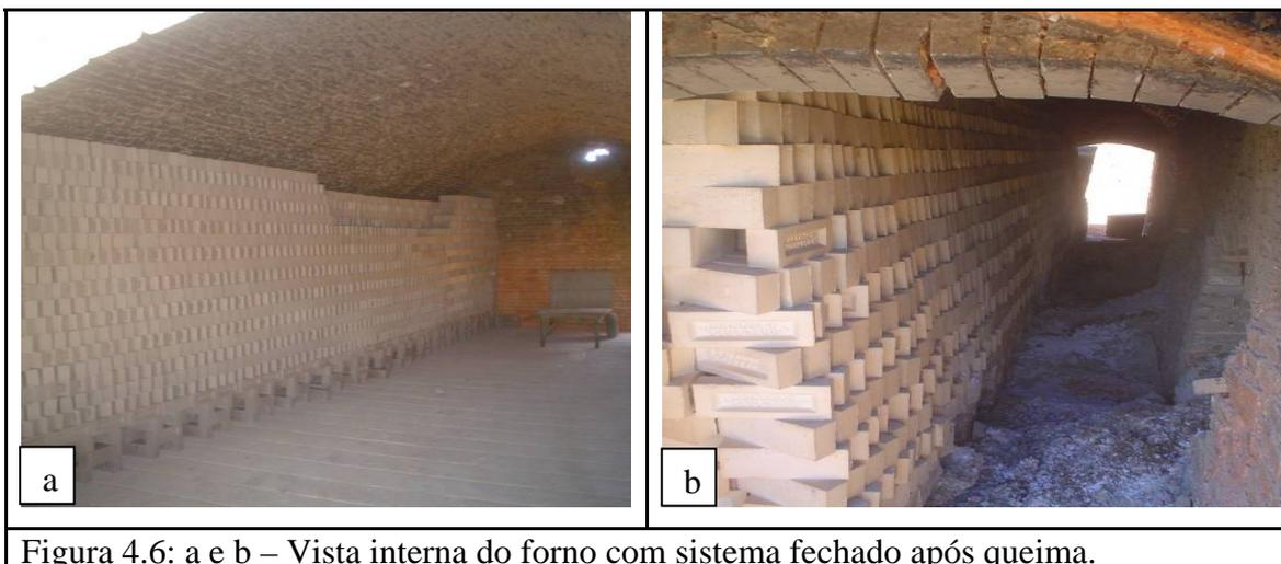
Observa-se que os fornos sem teto perdem calor facilmente, necessitando de maior quantidade de lenha para mantê-los aquecidos durante o processo de queima, o que poderia ser uma das explicações para a baixa relação de conversão biomassa/tijolo ou quantidade de calor/tijolo. Além disso, o desenho do forno varia quanto à forma de alimentação de lenha, o que também pode influenciar na eficiência.
