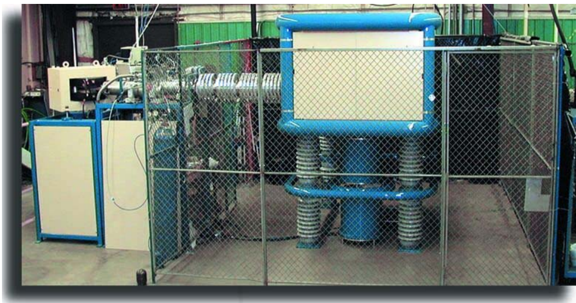
Figura 6 - Deck 250 kV onde ocorre a aceleração do SSAMS
