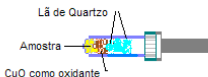
Figura 21- Desenho esquemático do tubo de ensaio contendo amostra utilizado no processo de combustão das gramíneas.
