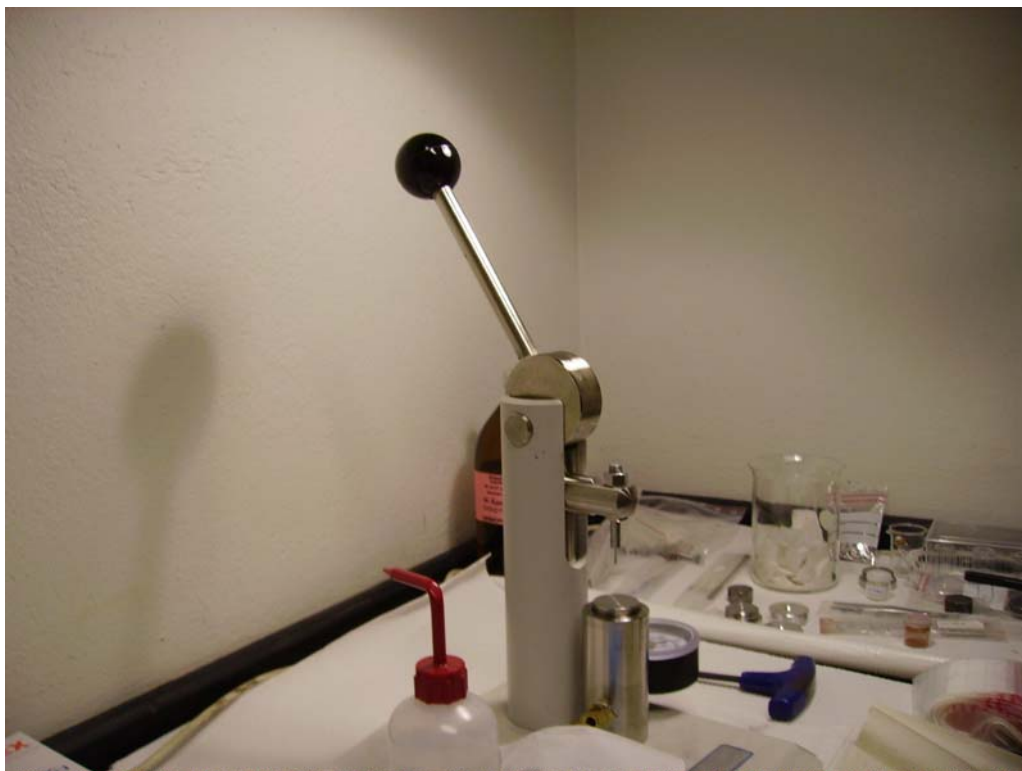
Figura 3 - Equipamento utilizado para prensar as amostras nos pequenos holders de alumínio para leitura no espectrômetro de massa com acelerador com um único estágio de aceleração (SSAMS)
