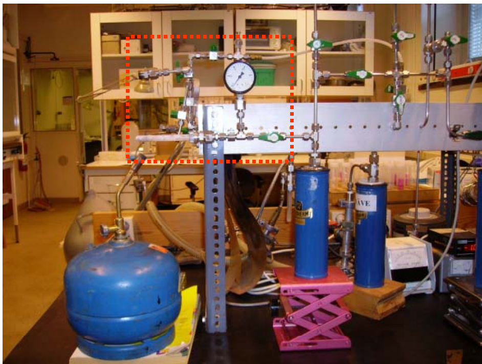
Figura 1 - Sistema de preparo das amostras localizado no Departamento de Física da Universidade de Lund, em Lund na Suécia. Nesta foto, o subsistema de produção de \text{CO}_2 está em evidência.
