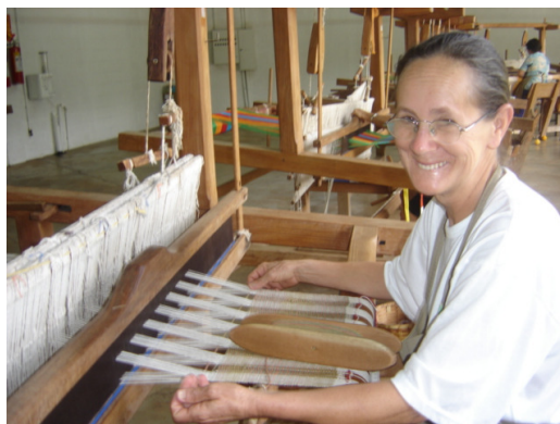
Figura 24 – Fotografia que mostra os fios do urdume separados para a passagem da lançadeira.
