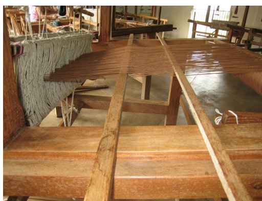
Figura 17 – Fotografia que mostra o detalhe dos entrelaçamentos dos fios (“cruz”) mantidos por estacas de madeira.
