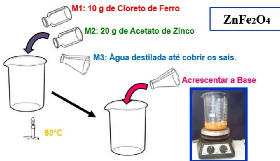
Figura 11: Processo de síntese da Ferrita de Acetato de Zinco.
