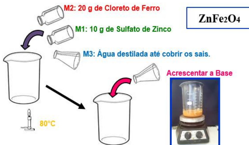
Figura 12: Processo de síntese da Ferrita de Sulfato de Zinco.
