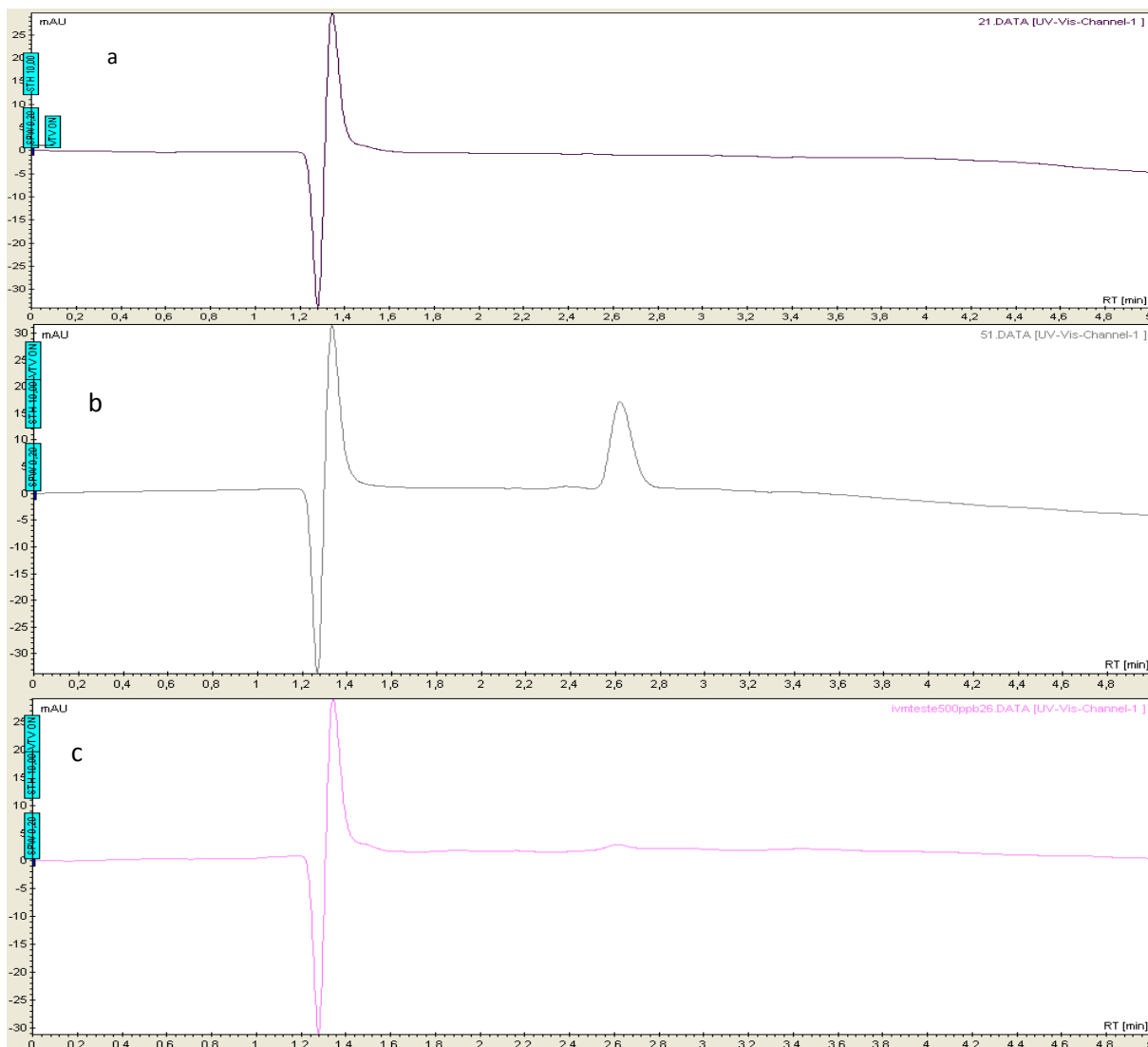
Figura 6. Cromatograma da solução padrão de ivermectina em metanol HPLC na concentração de 1000 µg/L com a fase móvel acetonitrila e água (70:30) (a), metanol, acetonitrila e água (65:30:5) (b) e metanol e água (80:20) (c), tempo de retenção 5 minutos, comprimento de onda 245 nm e fluxo de 0,7 mL/min.
