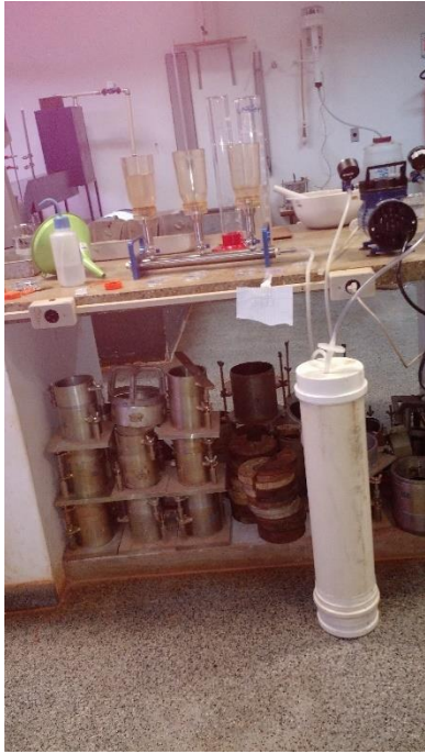
Figura 51: Estação para filtragem completa.
