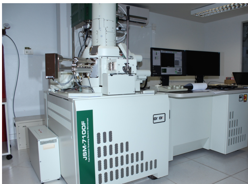
Figura 8 - Microscópio Eletrônico de Varredura usado (MEV) usado para análise das imagens.
