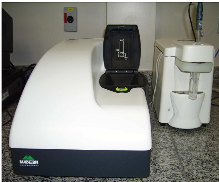
**Figura 13:** Zeta Sizer Nano e autotitilador MPT-2.
