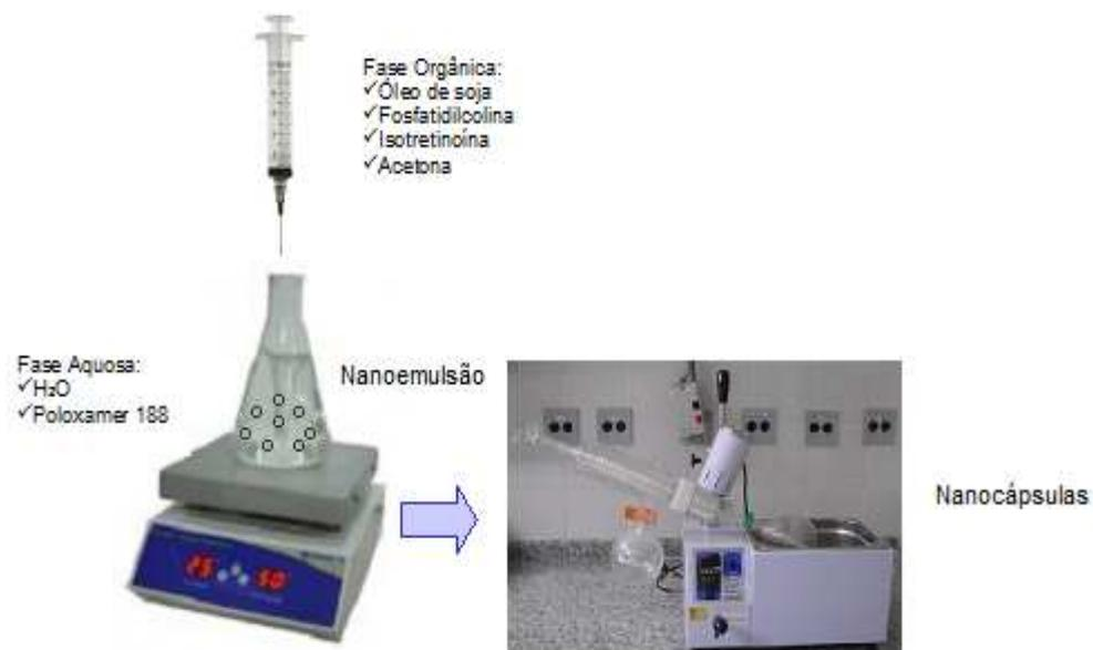
**Figura 12:** Método de preparo das nanocápsulas de PLA e PLGA pelo método de deposição do polímero pré-formado.
