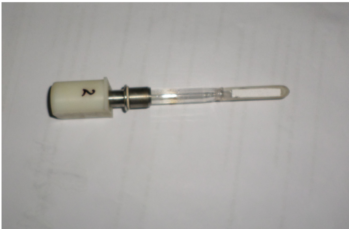
Figura 22. Amostra pronta para a leitura no equipamento: Alíquota cortada e colocada dentro do Boalt .
