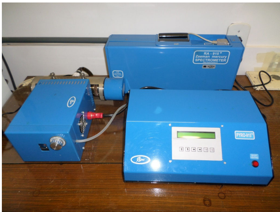
Figura 5. Espectrômetro de absorção atômica Zeeman RA-915+.
