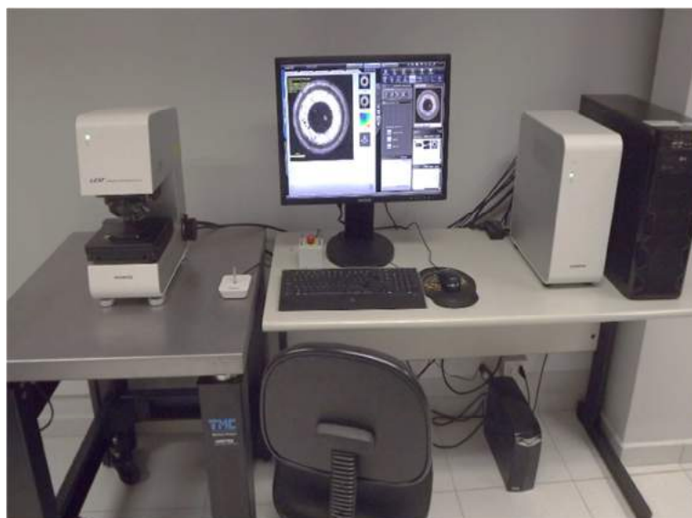
Figura 3.6 - Equipamento utilizado para microscopia óptica de precisão, microscópio LEXT OLYMPUS CONFOCAL LASER (Cortesia da imagem Marcus Sá).
