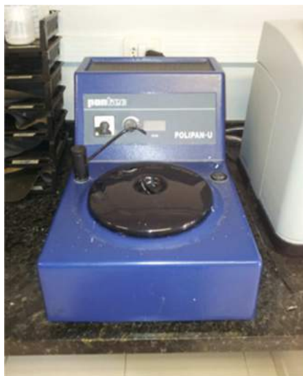
Figura 3.5 - Máquina de polimento POLIPAN-U , com disco giratório e jato d'água (Cortesia da imagem Marcus Sá).
