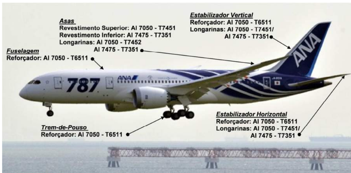
Figura 2.3 - Componentes de uma aeronave em ligas de alumínio da série 7XXX - Modificado de (E. A. Stake, 1995).
