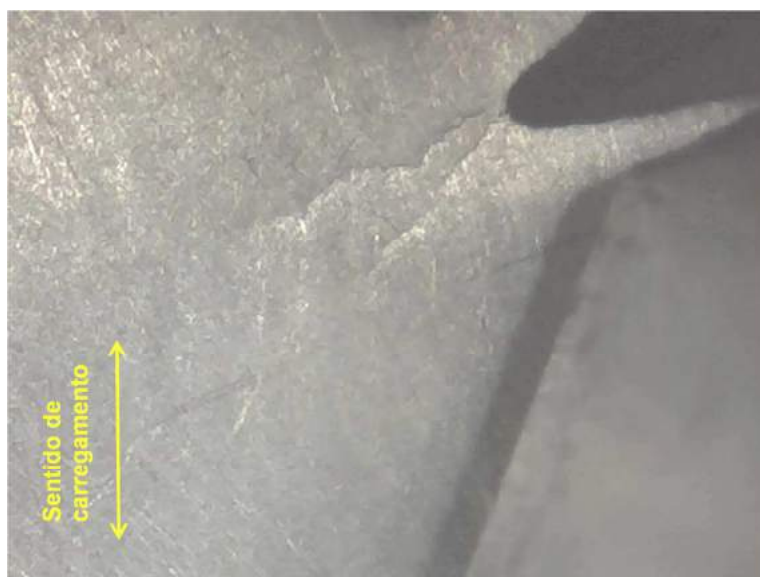
Figura 4.9 - Surgimento de bifurcação na execução da Pré-trinca.
