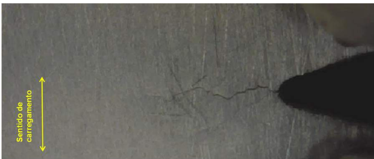
Figura 4.10 - Evolução de apenas uma das frentes de propagação (18000 ciclos).
