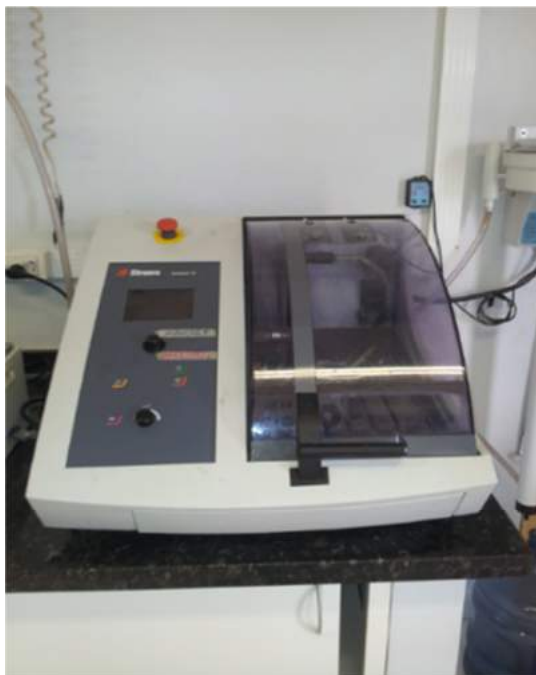
Figura 3.3 - Máquina de corte utilizada para retirada das amostras (Cortesia da imagem Marcus Sá).
