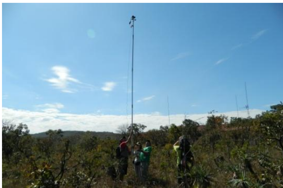
Figura 18- Procedimento de tomadas de fotografias no ponto 1 da trilha. Equipamento utilizado: Bastão de alumínio com uma câmera fotográfica e controle remoto. Autor: SILVA, R.G.P. (2013)
