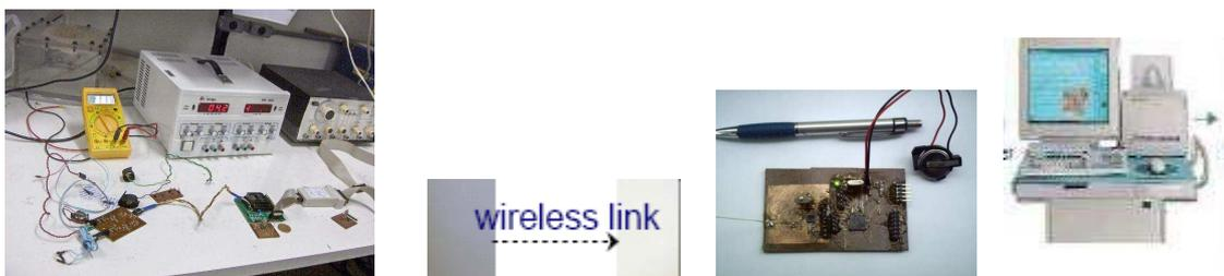
Figura 6.12 – Visão geral da RSSF aqui implementada para aplicações biomédicas. São observados os nodos sensores de sinais ECG, EMG, TC e RGP, placas para transmissão RF e recepção RF de sinais (constituídas pelo microcontrolador MSP430F149 e transceiver nRF2401), e um PC para visualização e análise dos sinais eletrofisiológicos.
