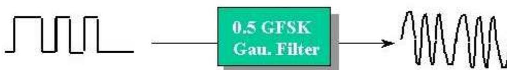
Figura 5.1 – Transformação dos pulsos pelo filtro gaussiano.
