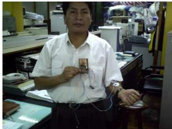
Figura 3.17 – Unidade remota portátil para transmissão e recepção sem fio (*wireless*) de sinais eletrofisiológicos.
