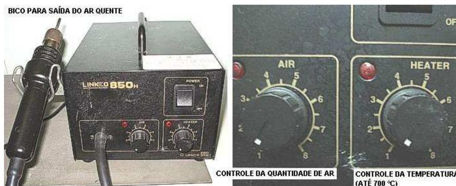
Figura B.1 – Soprador de ar quente.
