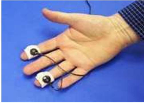
Figura 3.19 – Aplicação de eletrodos metálicos para captura de sinais RGP.
