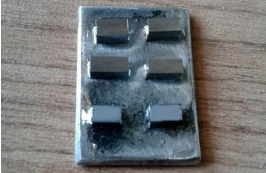
Figura 23 - Corpo de prova utilizado no ensaio de desgaste.
