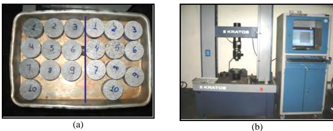
Figura 4.23. (a) Amostras prontas – ensaio de resistência à tração; (b) Vista do equipamento para o ensaio à tração.
