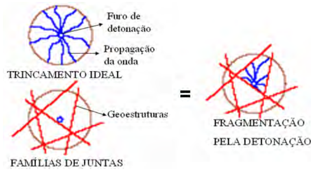
Figura 2.13. Efeito das geoestruturas na fragmentação do maciço rochoso.
