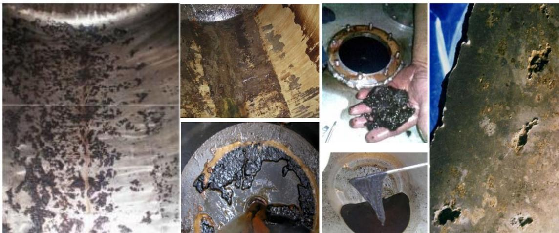
**Figura 2:** Fotografias de produto formado a partir da oxidação, auto-oxidação e contaminação microbiológica do biodiesel. FONTE: Posto Ipiranga e Petrobrás (2010); Zimmer *et. al*. 2011
