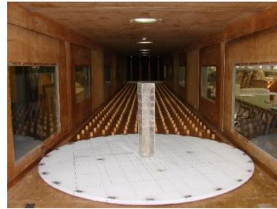
Figura 3.18 – Ensaio experimental do edifício isolado: a) malha base inserida na mesa de ensaios e suas orientações; b) imagem do CAARC sendo ensaiado no túnel de vento Professor Joaquim Blessmann.
