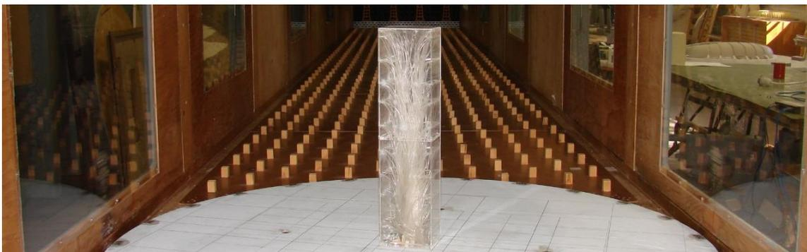
Figura 2.1 – Fotografia do interior do túnel de vento mostrando a simulação da rugosidade do terreno.
