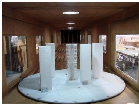
Figura 3.6 – Dispositivos à barlavento e blocos no piso para a simulação adequada de velocidade e turbulência.
