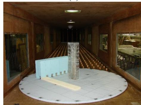
Figura 3.19 – Sequência dos ensaios da Vizinhança 1: a) desenho de V1 na mesa giratória e suas orientações; b), c), d), e), f) ensaio no túnel de V1.
