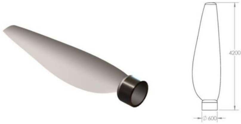
Figura 5.1 – Dimensões de uma pá de rotor de turbina eólica (Kalkmann, 2012).
