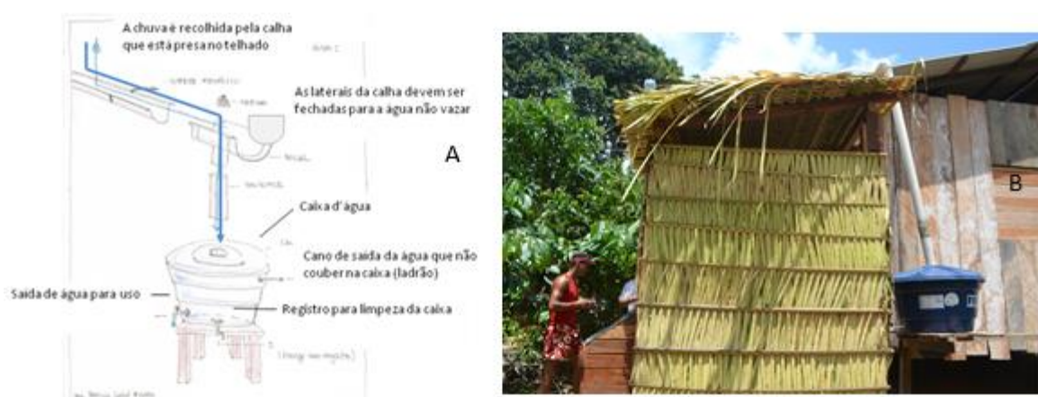
Figura 7 – (A) Esquema do sistema de captação de água da chuva implementado junto com os sanitários secos (B).
