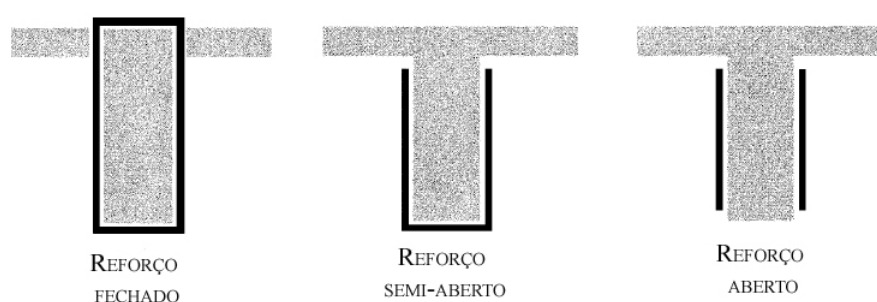
Figura 2.5 – Formatos de reforço ao cisalhamento. Adaptado ACI440.2R (2008)
