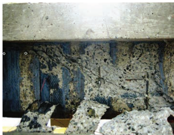
(c) Fissura principal de falha por cortante. Mofidi e Chaallal (2014)
