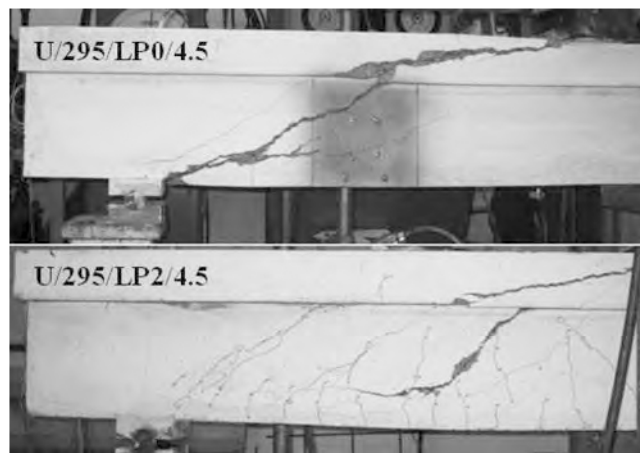
(a) Fissura principal de falha por cortante. Dirar et al. (2012)
