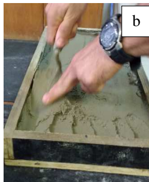
Argamassa aplicada sob pressão com a colher de pedreiro de modo a cobrir homogeneamente a superfície do substrato.
