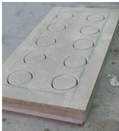
Figura 3.24 – Substrato padrão com 10 corpos de prova cortados cerca de 1mm de profundidade.
