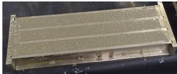
Figura 3.14 – Moldagem de corpos de prova para a realização dos ensaios de variação dimensional.
