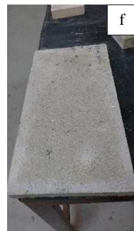
Argamassa após a desforma
