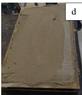
A segunda camada de argamassa, completando a espessura definida em norma, com ligeiro excesso para rasar com régua metálica, ficando uma espessura final de 20 mm.
