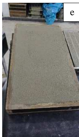
Argamassa com a camada rasada.
