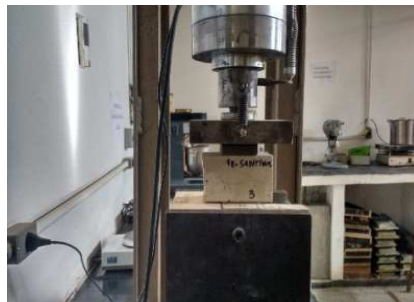
Figura 3.18 – Realização do ensaio de resistência à compressão.
