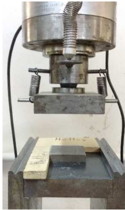
Figura 3.17 – Posicionamento do corpo-de-prova e rótula adaptada para o ensaio de resistência à compressão.
