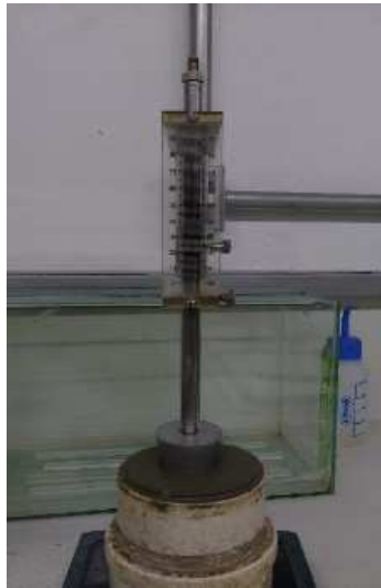
Figura 3.10 – Ensaio de penetração de cone.
