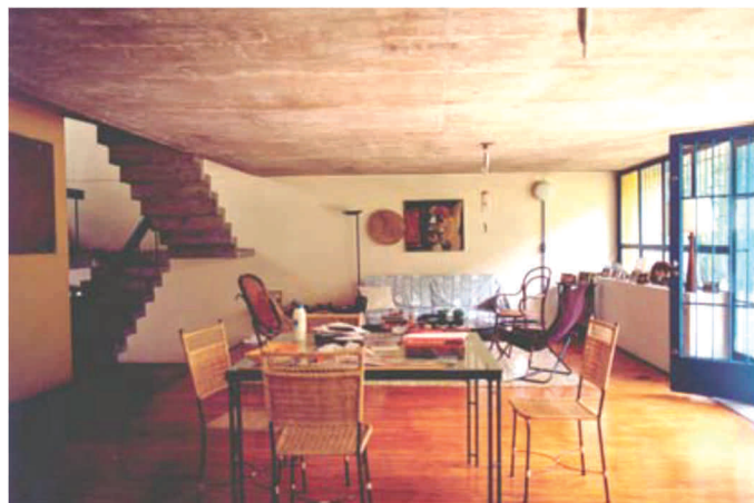
Figura 23 - Imagem interna da Residência Ruth Vampré. É possível notar as instalações aparentes, os pisos intercalados e as grandes aberturas para o jardim, à direita. Fonte: GUIMARÃES, 2006.
