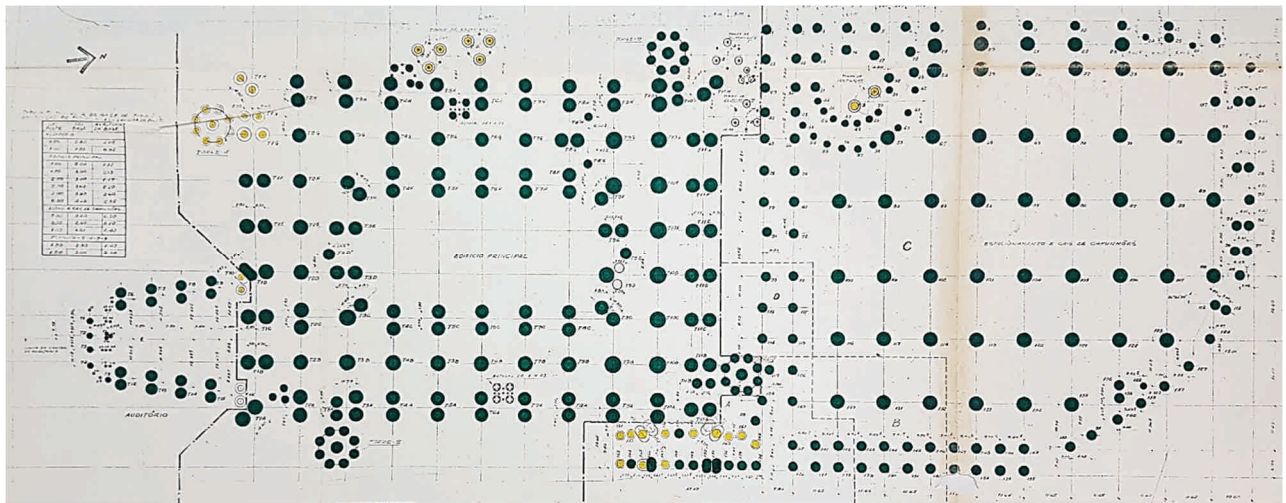
Figura 77 - Demarcação das escavações. Através do desenho é possível notar que, de toda a implantação do edifício, apenas parte do estacionamento Norte não foi escavado. Fonte: D.N.E.R. – Relatório de Produção e Progresso, 1976
