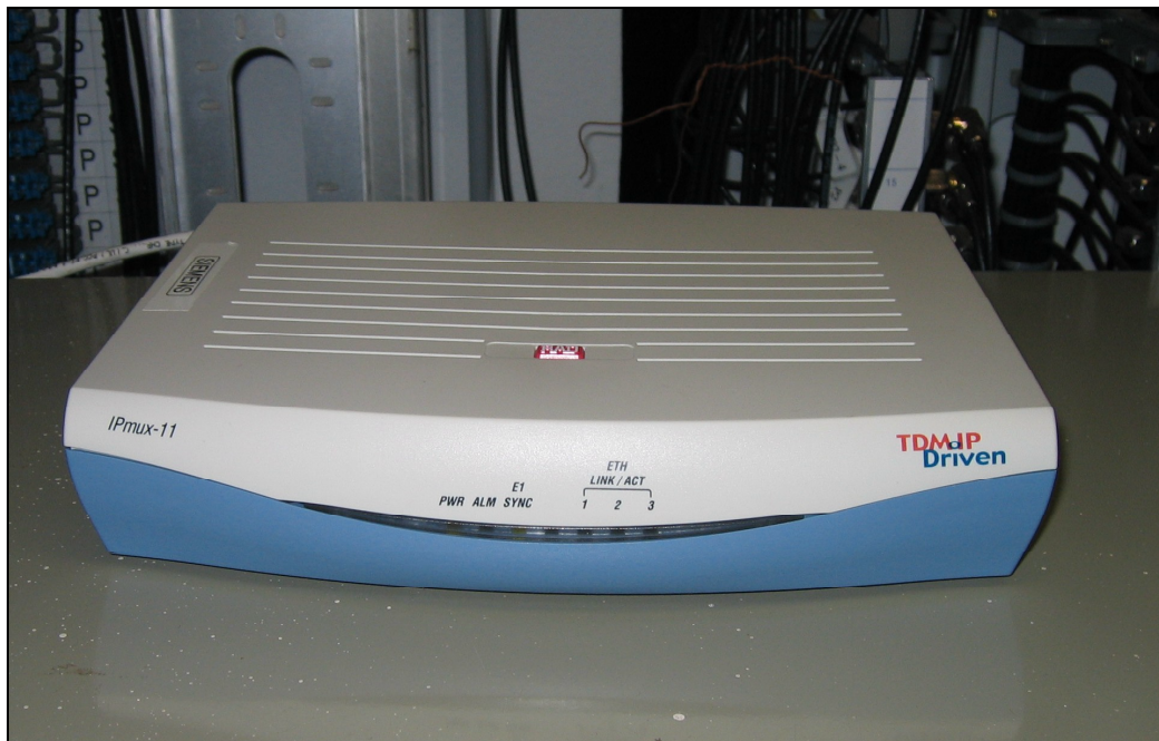
Figura 4.22 - Gateway IPmux-11 da RAD utilizado nos testes.
