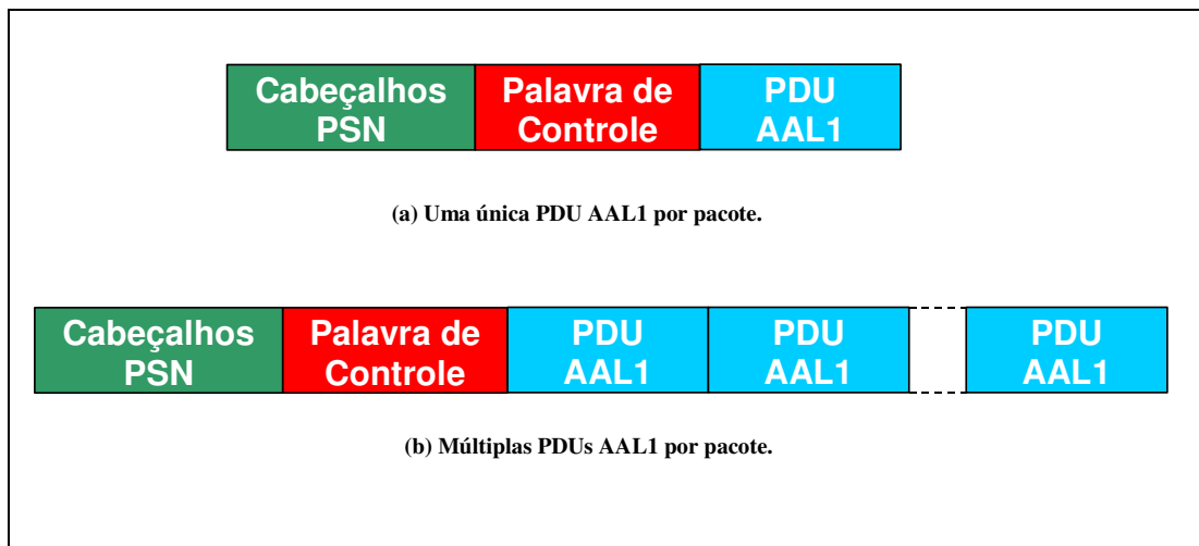
Figura C.10 - PDUs AAL1 dentro dos pacotes TDMoIP ® .
