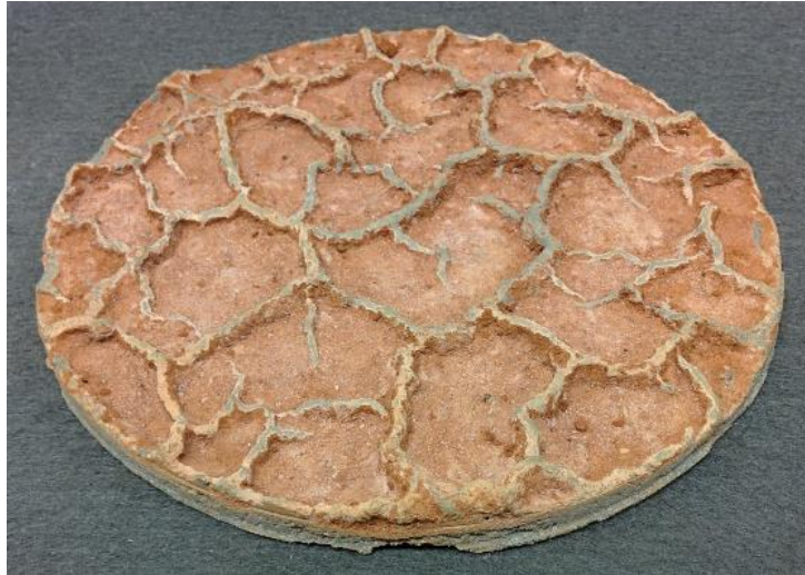
Figura 3.22 – Detalhe do molde produzido com nata de graute e aditivo de pega super rápida.
