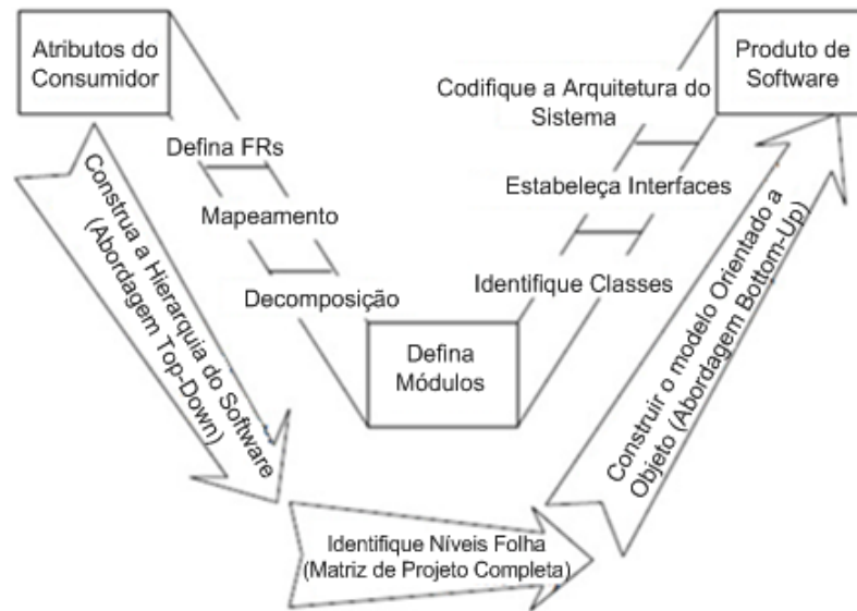
Figura 4.4: Processo de Projeto Axiomático para Sistema de Software Orientado a Objeto (Modelo V)
