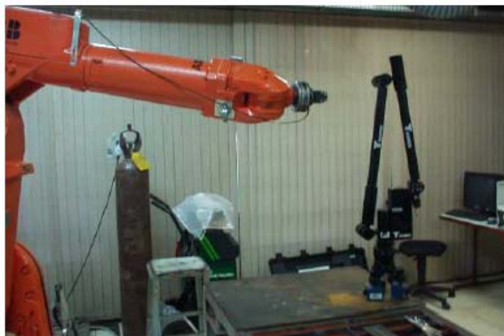
Figura 6.3: Braço medidor ITG ROMER e manipulador IRB2000, de (Ginani L.S. ,2005).
