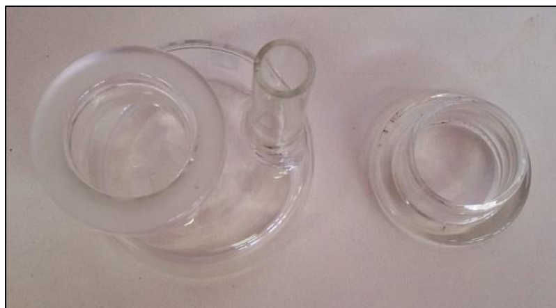
Figura 15: Célula de difusão de Franz modificada utilizada no ensaio de permeação in vitro
