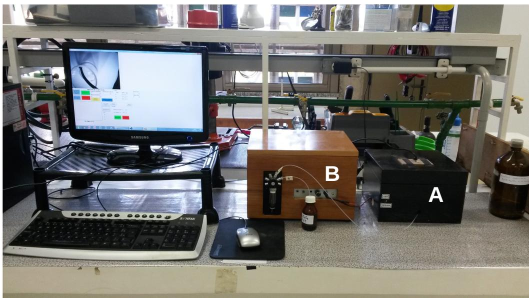
Figura 7: Titulador montado. (A) Caixa de ambiente de luz controlada com bquer e câmera *webcam*. (B) Bomba-seringa.
