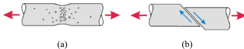
Figura 3.12. Critérios de situações de falha. (a) critério dúctil; (b) critério de falha por cisalhamento. (ABAQUS, 2005).
