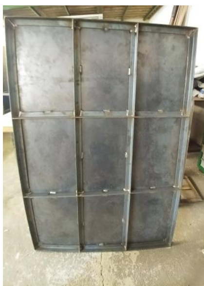
Figura 88 - Montagem da parte inferior da plataforma.
