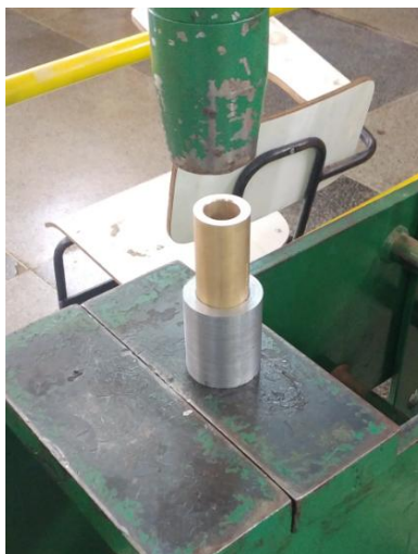
Figura 92 - Prensa hidráulica durante o processo de montagem da peças.
