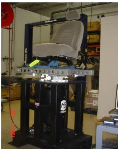
Figura 4 - Exemplo de bancada comercial de vibração de corpo inteiro para assentos automotivos. (MB Dynamics).
