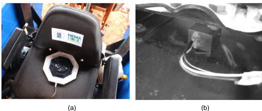
Figura 9 - (a) Acelerômetro usado no assento. (b) Acelerômetro usado na base do assento (FRANCHINI, 2007).
