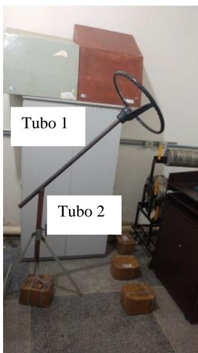
Figura 96 - Tripé e o sistema de elevação do volante: (a) Sistema de elevação do banco, (b) Mecanismo de ajuste de altura.
