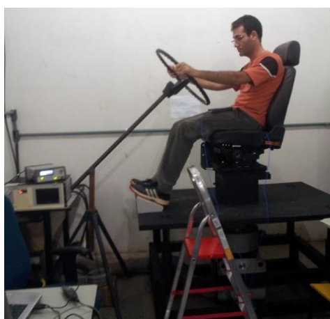
Figura 111 - Medição de vibração de corpo inteiro em banco rodoviário com ocupante
