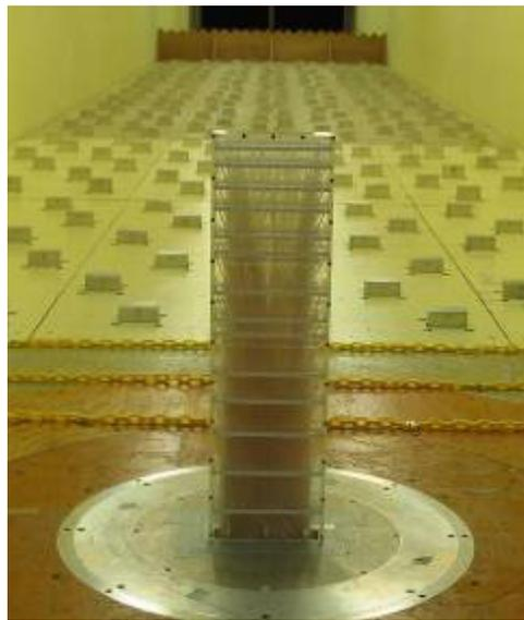
Figura 4.9 – Modelo reduzido com tomadas de pressões usando a técnica HFPI (Tse et al., 2009).
