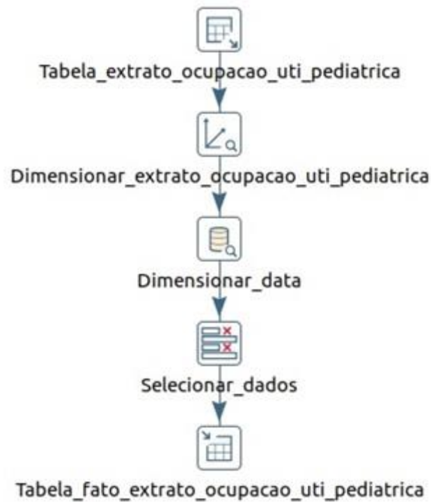
Figura 25: Fluxograma do processo de criação da tabela Fato Extrato de Ocupação UTI Pediátrica, utilizando o Kettle . Fonte: Autor.
