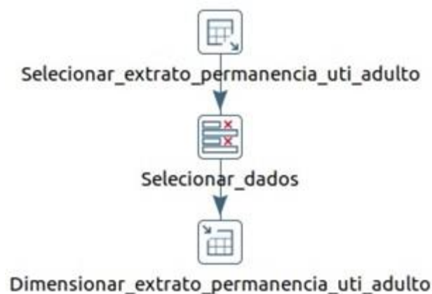
Figura 19: Fluxograma do processo ETL do Extrato de Permanência UTI Adulto dos HUFBs, utilizando o Kettle . Fonte: Autor.
