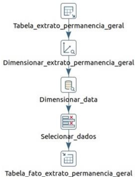
Figura 26: Fluxograma do processo de criação da tabela Fato Extrato de Permanência Geral, utilizando o Kettle . Fonte: Autor.
