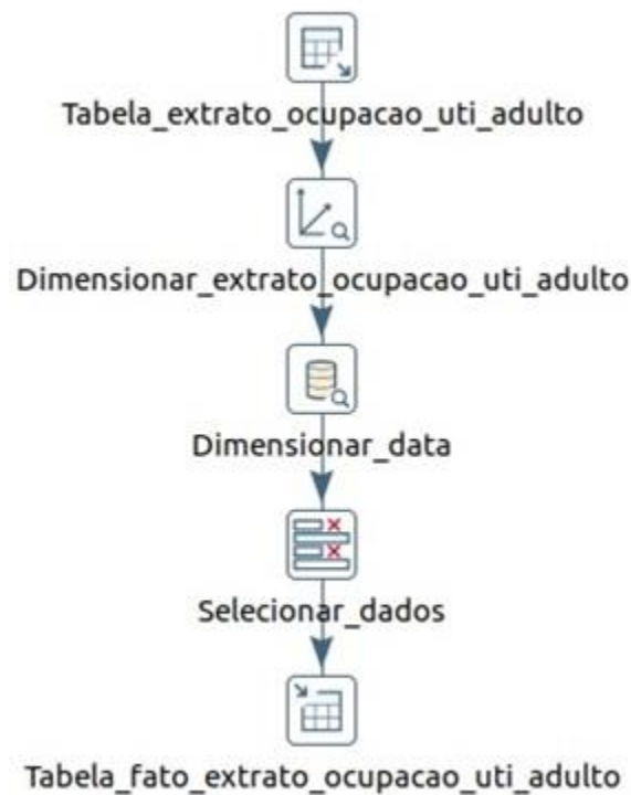
Figura 24: Fluxograma do processo de criação da tabela Fato Extrato de Ocupação UTI Adulto, utilizando o Kettle . Fonte: Autor.
