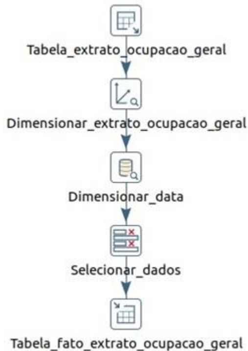
Figura 22: Fluxograma do processo de criação da tabela Fato Extrato de Ocupação Geral, utilizando o Kettle . Fonte: Autor.
