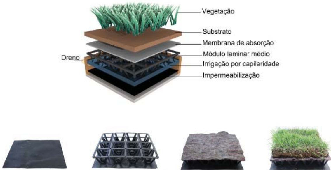
Figura 32: Sistema laminar médio Ecotelhado
