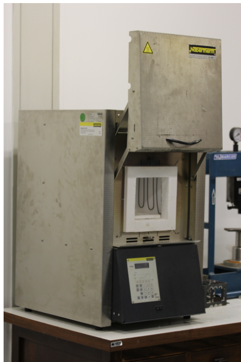
Figura 3.12: Forno Nabertherm utilizado nos tratamentos térmicos de normalização dos corpos de prova.
