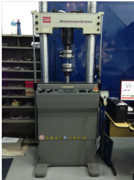
Figura 3.9: Máquina de ensaios servo-hidráulica axial/torcional MTS 809.
