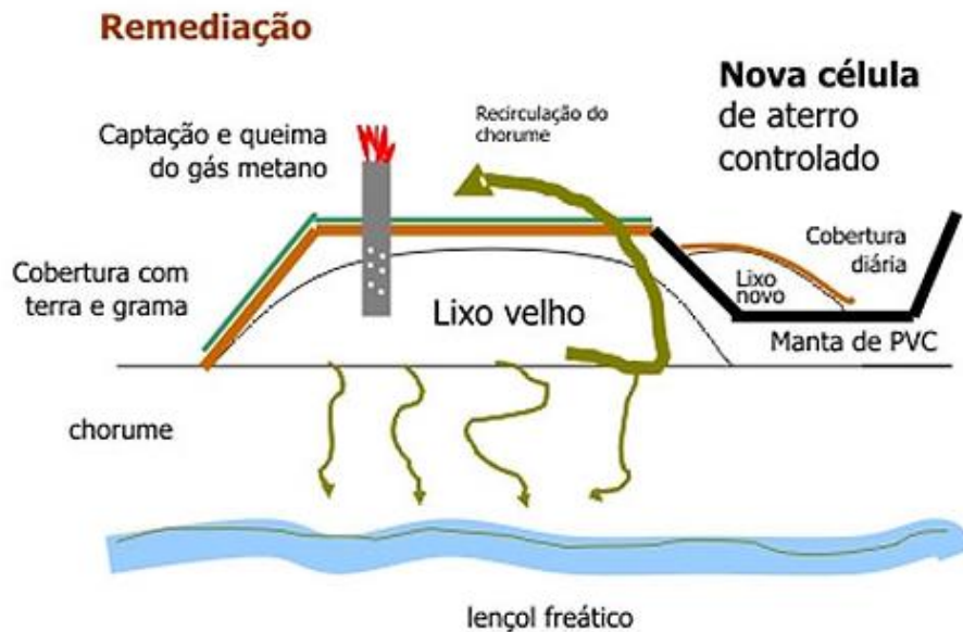
Figura 3.3 – Esquema ilustrativo de aterro controlado (Oliveira, 2010).
