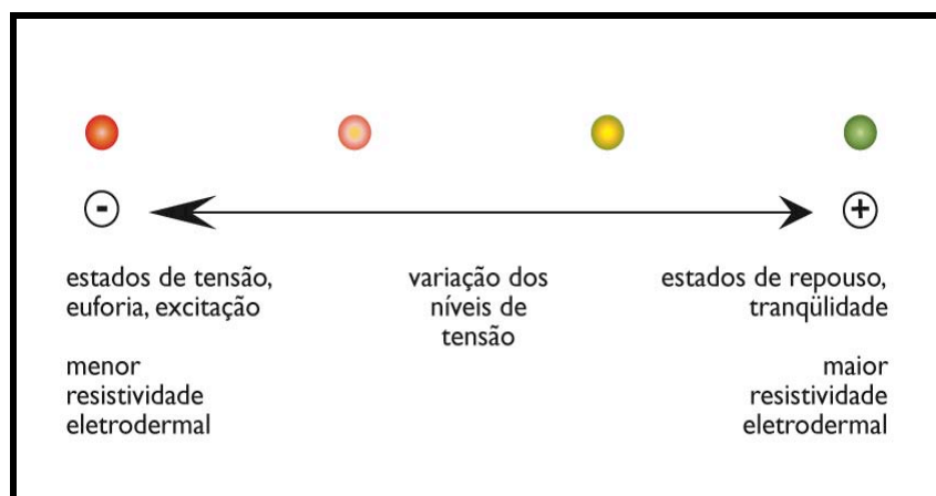
Figura 71: Esquema ilustrativo do funcionamento do sistema, as cores demonstram as cores do LED e suas variações.
