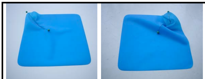
Figura 44: Teste com fio de nitinol e silicone. Ao receber o estímulo térmico (água quente), o nitinol altera sua forma para a forma previamente programada. Com a ausência de estímulo ele se estica. Fotos cedidas por Tania Fraga.
