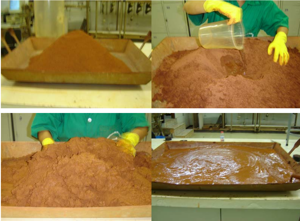
Figura 4.1 – Seqüência de preparação da amostra.
