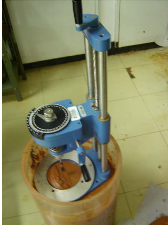
Figura 4. 4 – Determinação da resistência ao cisalhamento do solo
