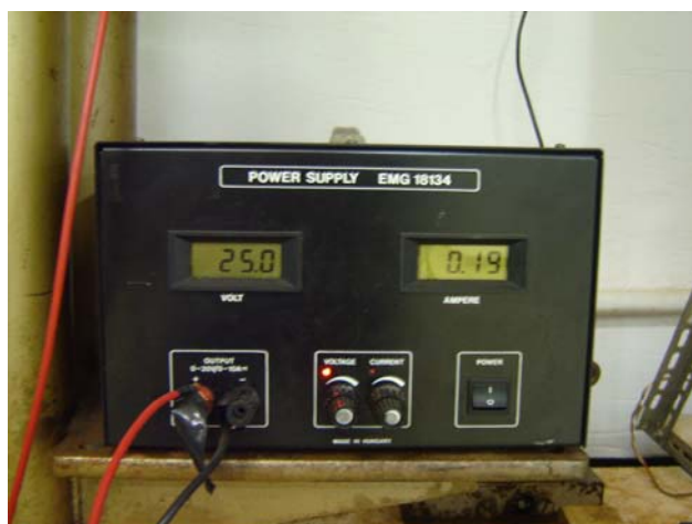
Figura 3.3 – Fonte de alimentação elétrica
