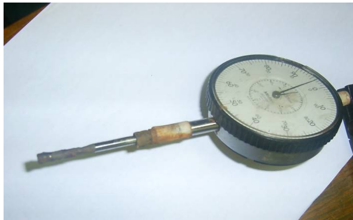
Figura 5.12 - Corrosão apresentada pelo extensômetro 02
