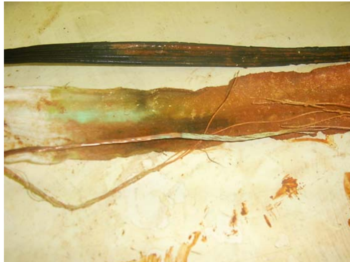
Figura 5.38 – Ânodo completamente desagregado
