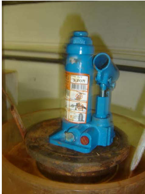
Figura 4.6– Macaco hidráulico com capacidade de 2 tf, sobre anteparo na célula eletro-osmótica.
