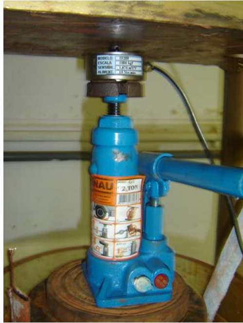
Figura 4.2 – Instalação do macaco hidráulico e da célula de carga
