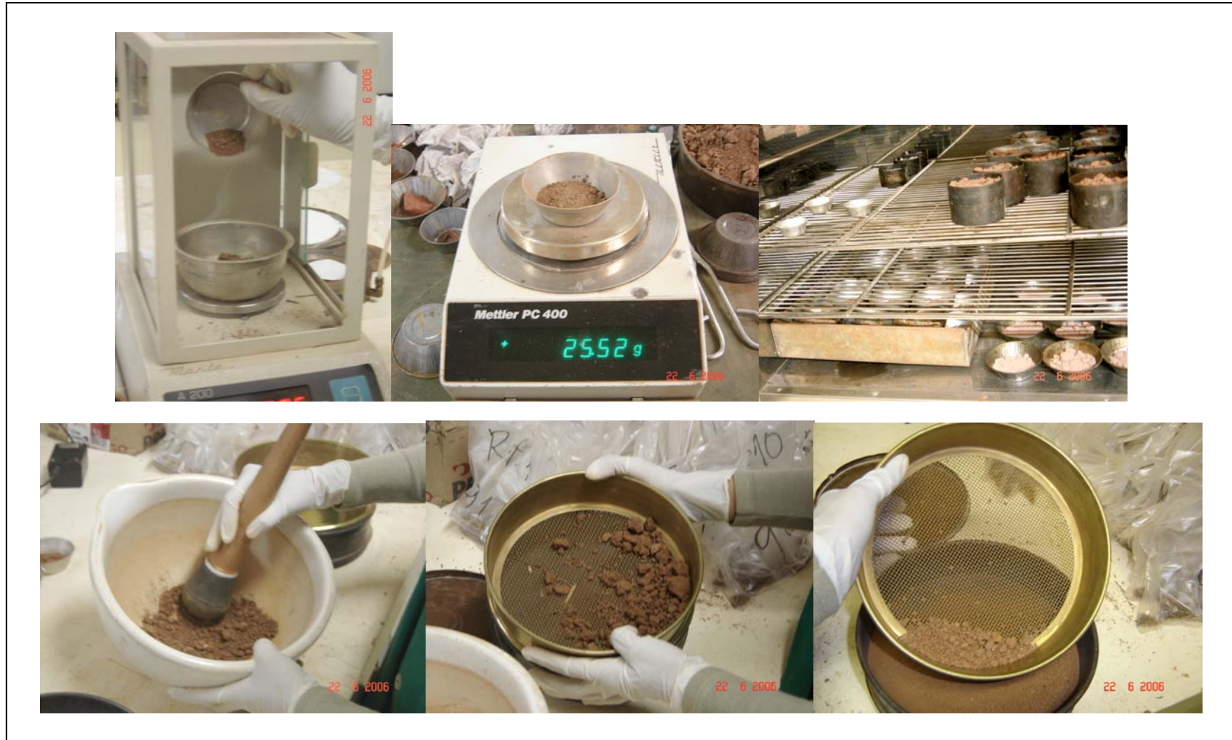
Figura 6.2.1.1 Etapas de preparo utilizadas para ensaios realizados no granulômetro a laser.
