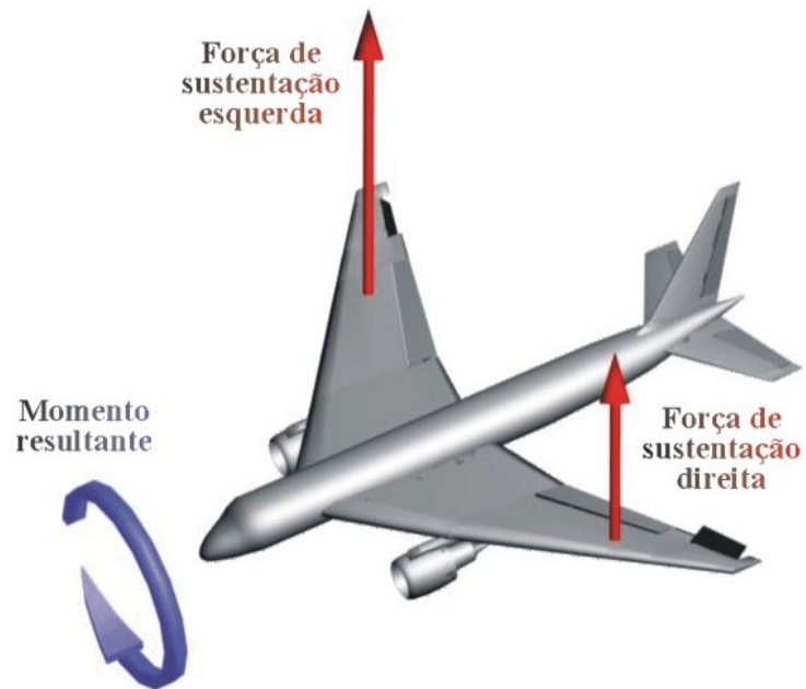
Figura 1.6 – Efeito da atuação dos ailerons.
