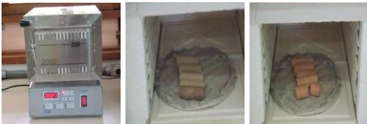
Figura 3. 6 – Forno mufla utilizado e amostras antes e após queima a  $900^{\circ}\text{C}$ .
