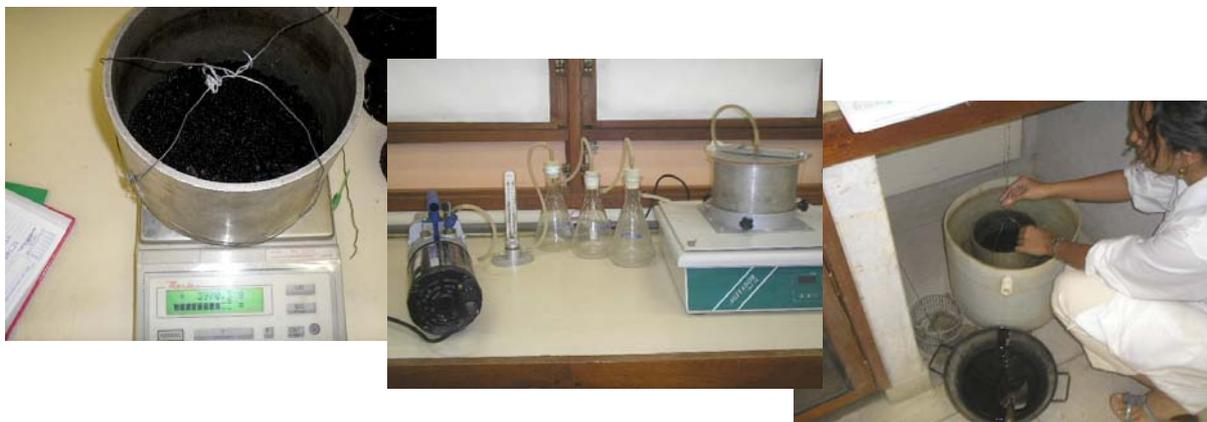
Figura 3. 29 – Procedimentos segundo o Rice Test (ASTM-2041).
