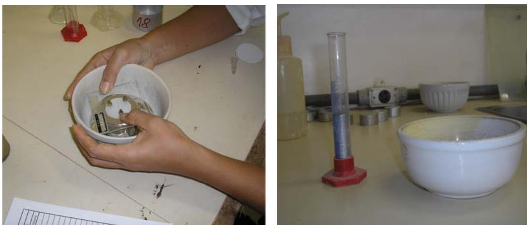
Figura 3. 16 – Medição de volume utilizando mercúrio.
