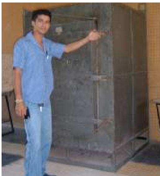
Figura 3. 15 – Forno utilizado para queima do agregado em grandes quantidades.
