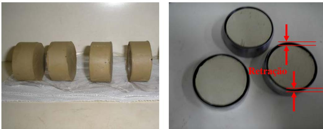
Figura 4. 2 – Corpos de prova para avaliação da retração do solo.
