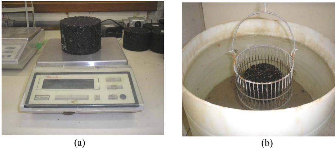
Figura 3. 25 – Determinação dos índices físicos.
