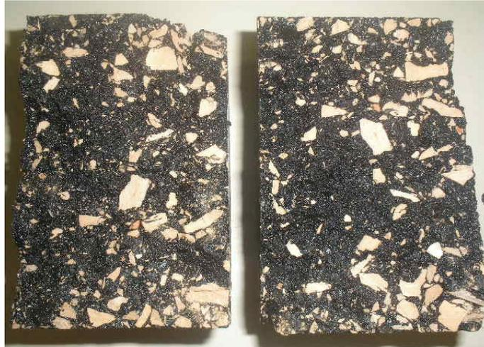
Figura 4. 8 – Corpo de prova da Mistura M2 (Superpave), após ensaio de RT.
