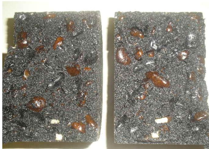
Figura 4. 9 – Corpo de prova da Mistura M3 (Seixo), após ensaio de RT.
