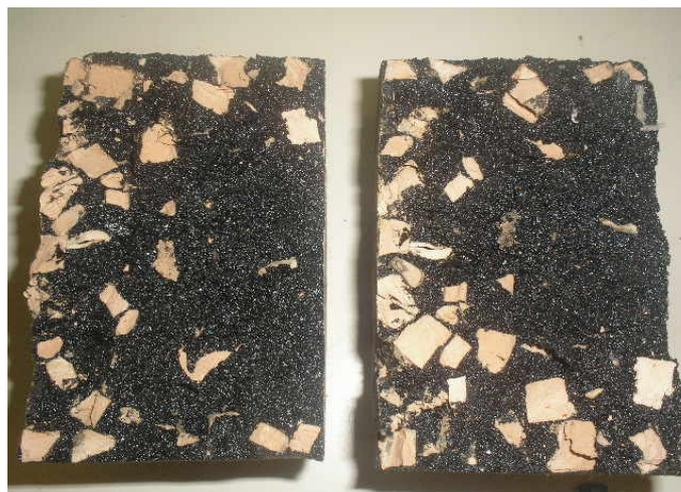
Figura 4. 7 – Corpo de prova da Mistura M1(Faixa C), após ensaio de RT.
