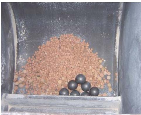
Figura 3. 9 – Ensaio de desgaste por abrasão “Los Angeles”.
