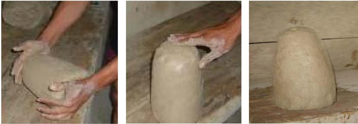
Figura 3. 11 – Moldagem do “tarugo” de argila.
