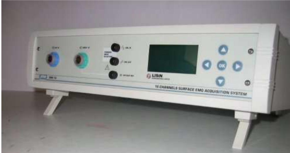
Figura 1.3: Eletromiógrafo de 16 canais Fabricado pela - OT Bioelettronica. (Retirado de LISIN, V3.1a)
