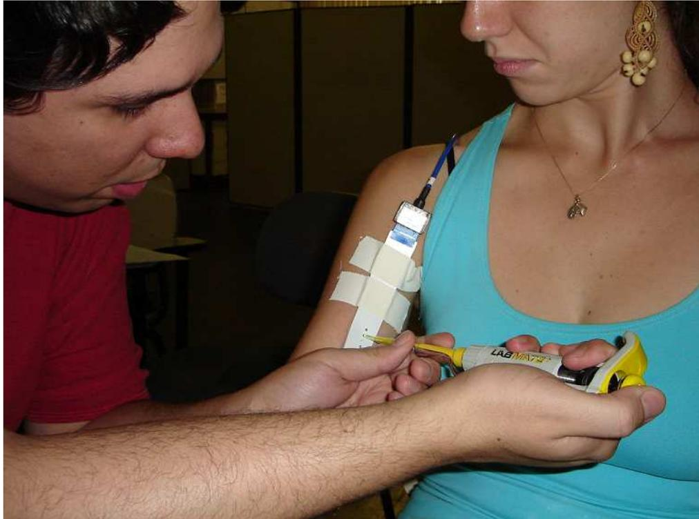
Figura 2.5: inserção de gel condutor em cada um dos orifícios sobre os eletrodos de captação. Para a inserção do gel foi utilizada uma micropipeta.
