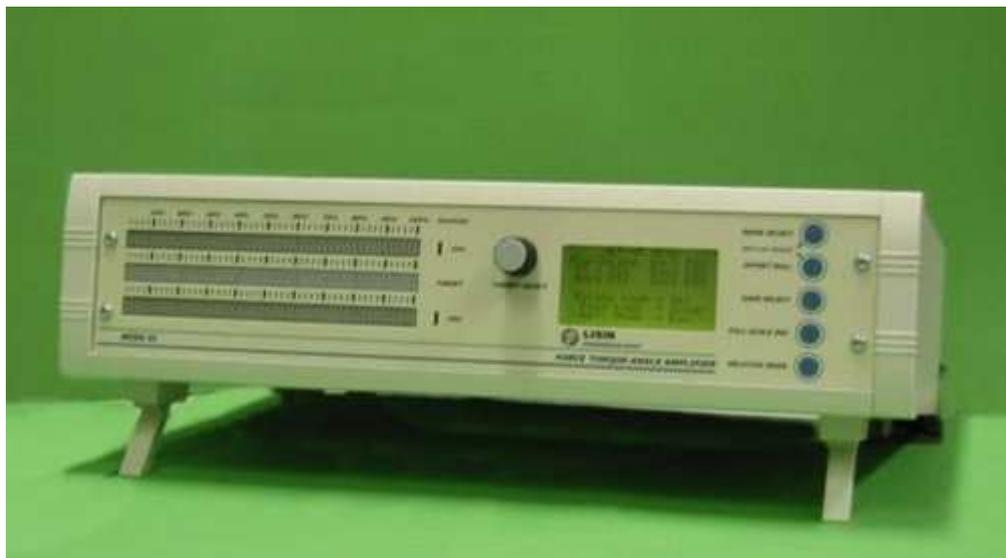
Figura 1.4: amplificador de canais biomecânicos MISO II – OT Bioelettronica
